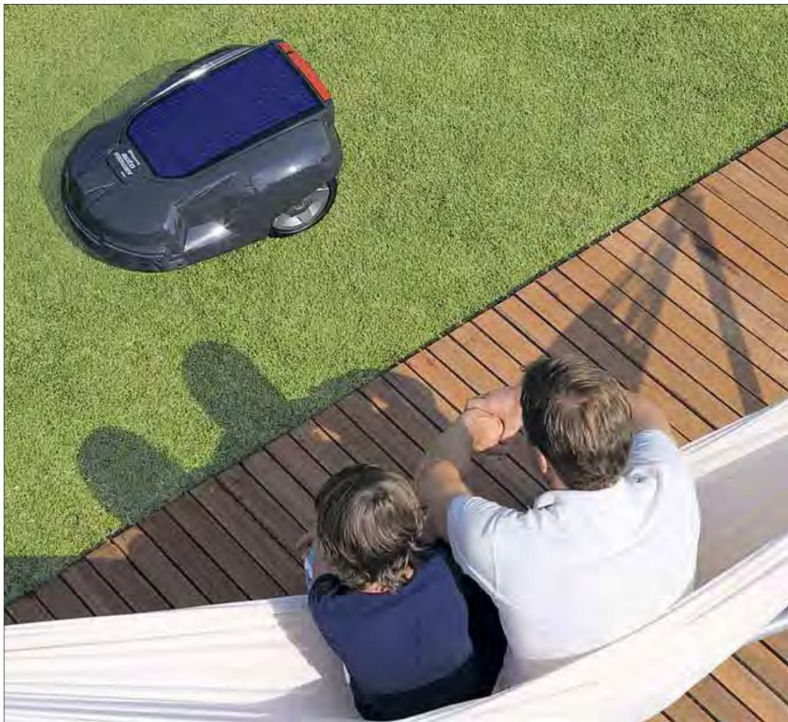
Con l'Automower Solar Hybrid Husqvarna, l'azienda pioniera del settore, propone un modello dotato di un pannello solare in grado di tosare l'erba gratis con l'energia solare quando il cielo è terso. Grazie alla tecnologia ibrida, il tosaerba non dipende però dal bel tempo. Quando infatti non è disponibile la corrente solare, ricarica la sua batteria alla stazione di ricarica. Con l'aiuto dell'energia solare il robot tosaerba può tagliare l'erba più a lungo senza interruzioni.
