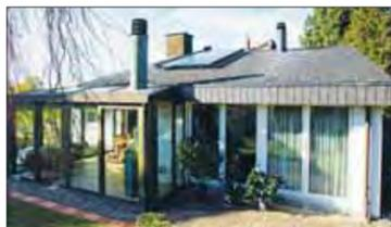
**Un investimento che paga.** Il vecchio riscaldamento a gasolio ha lasciato il posto a una pompa di calore salamoia-acqua e a un impianto solare: il consumo energetico è diminuito di oltre il 70 per cento.
