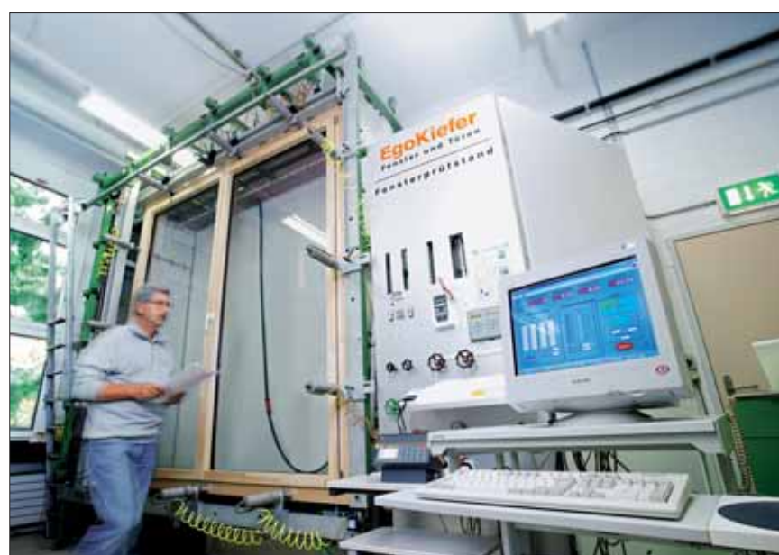
Le nuove costruzioni di finestre vengono collaudate in laboratorio alle condizioni più estreme. (Foto: EgoKiefer SA)
