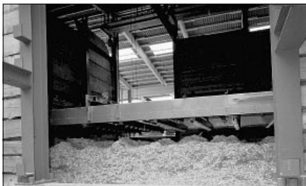
**Sistema di carico e scarico mediante trasportatore a palette raschianti a catena mobili, orizzontali e verticali**
