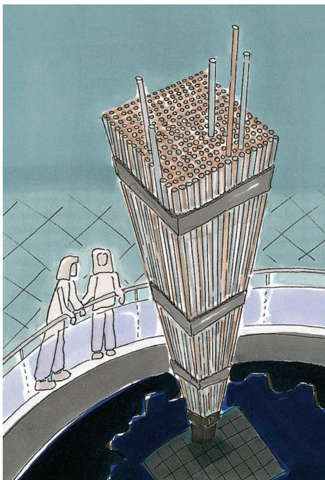
gono introdotte una a una in barre combustibili che racchiuse in fasci vengono messe nel cuore di un reattore nucleare. Il reattore è pieno d'acqua e protetto da strati di cemento armato. L'uranio è fatto di miliardi di minuscole particelle, gli atomi. Ogni atomo possiede un nucleo. Quando questo nucleo viene spezzato (fissione), sprigiona energia nucleare. Il calore che si libera con la fissione viene usato per produrre elettricità (vedi «La produzione di corrente elettrica», pagina 16).
