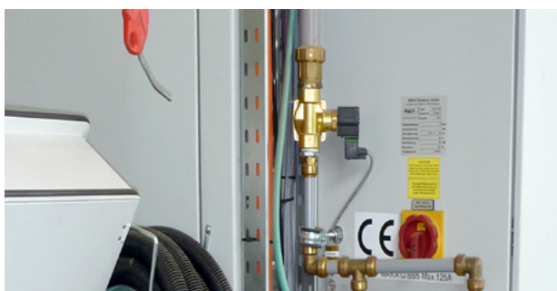
La valvola elettromagnetica si scollega automaticamente dalla rete dell'aria compressa.
