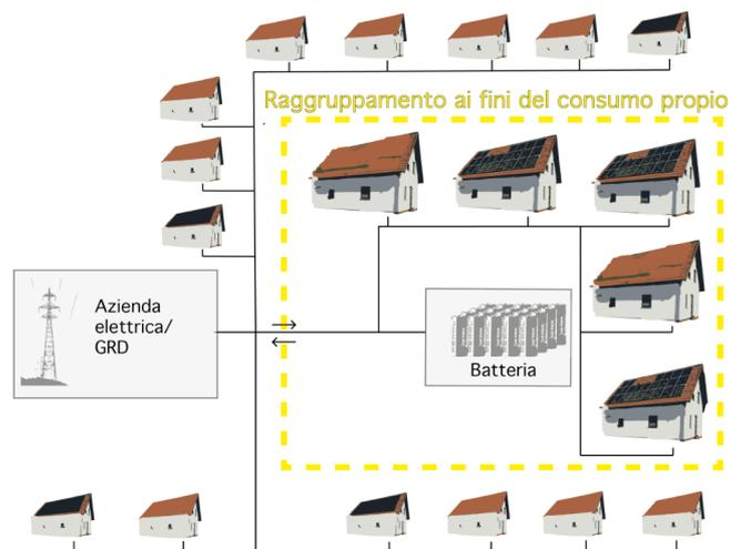
Il raggruppamento ai fini del consumo proprio (RCP) dispone di una propria rete elettrica collegata alla rete dell'azienda elettrica locale tramite un unico punto di prelievo. Attraverso questo collegamento, l'RCP può immettere l'energia solare in eccesso nella rete locale o prelevare energia dalla rete se il fabbisogno delle economie domestiche dell'RCP non può essere soddisfatto da impianti fotovoltaici e accumulatori a batteria. Illustrazione: B. Vogel
