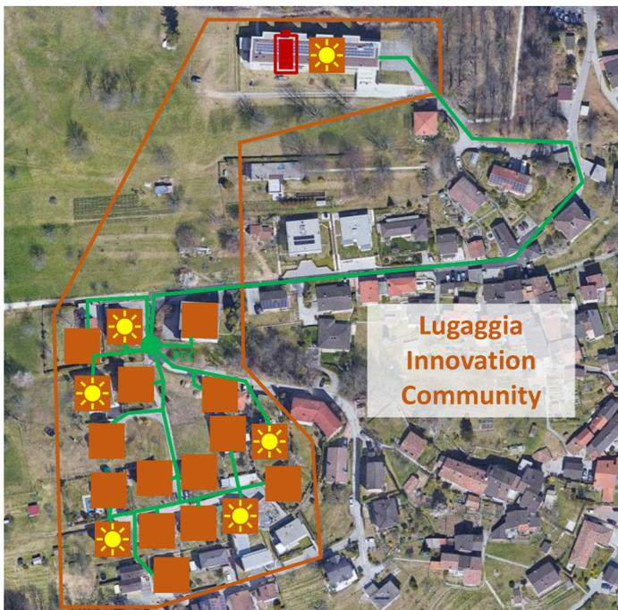
L'RCP comprende sei impianti fotovoltaici (simbolo del sole): un impianto fotovoltaico sul tetto della scuola dell'infanzia (in alto) e 5 altri impianti sui tetti di privati. A questi si aggiunge un accumulatore a batteria. Illustrazione: AEM
