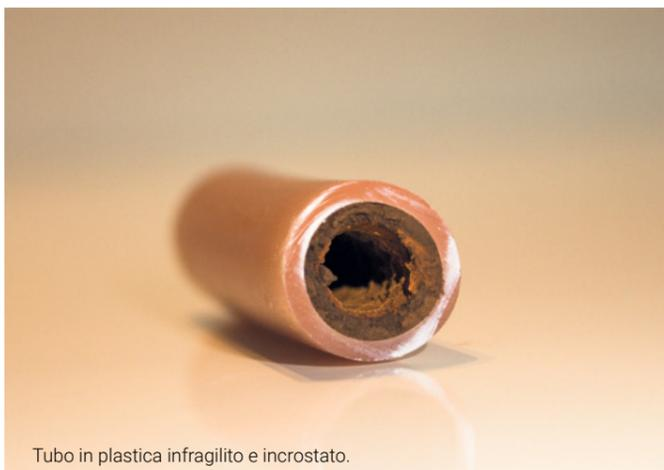
Tubo in plastica infragilito e incrostato.
