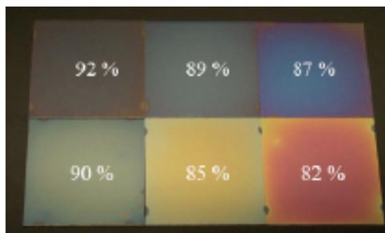
**Figure 3 :** échantillons de verre solaire colorés en couches minces interférentes par le procédé SolGel
