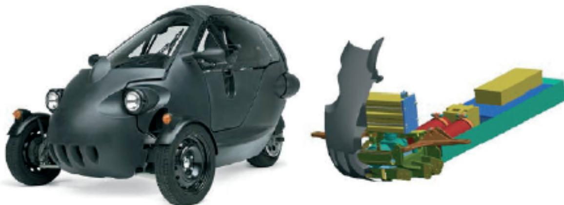
**Figur 7:** Elektrofahrzeug SAM I und die voraussichtliche Positionierung des 6kW-Stapels im CAD-Modell.
