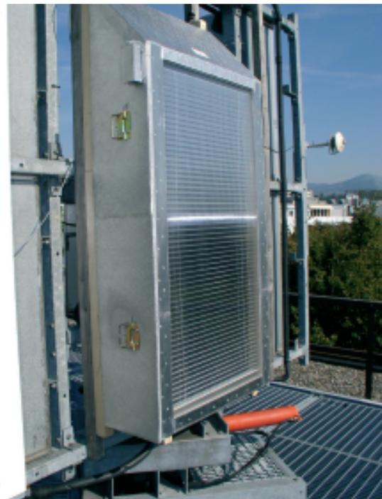
**Figure 2** : nouveau banc test de façade solaire verticale, développé par le SPF dans le cadre de SOLABS
