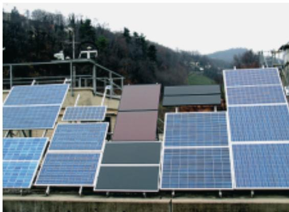
**Figur 6:** TISO PV Modulteststand
