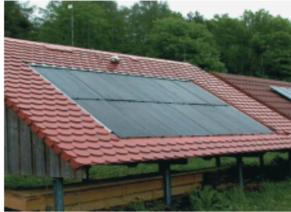
**Figur 5:** Prototypanlage für den Freilufttest mit CIS-Elementen im Projekt HIPERB (Bildquelle 3S)
