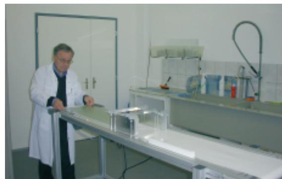
**Figur 11:** Aufbau der Pulverpräparation und die Bandgießeinrichtung für die Pilot-Fabrikation von SOFC-Stapeln
