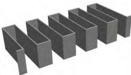
**Fig. 2-13** Déversoir labyrinthe [11]
