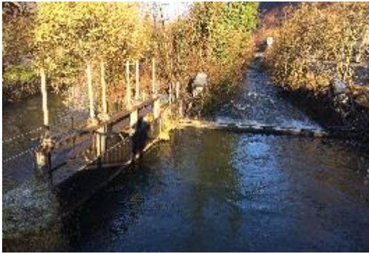
**Fig. 2-4 Prélèvement latéral (à gauche) avec déversoir mobile**
