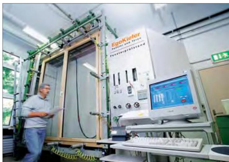
**Les fenêtres nouvellement construites sont testées dans des conditions extrêmes par le laboratoire d'essais qui les passe au peigne fin.**
