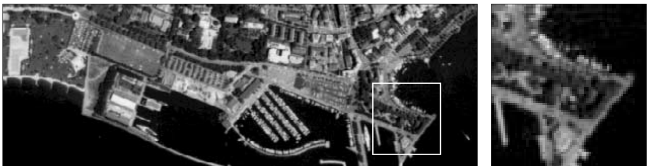
Figure 2.39: Photo scannée – une photo ne peut pas être vectorisée automatiquement (chaque pixel est indépendant de tous les autres).
