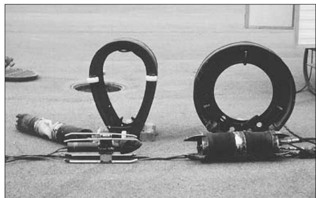
Figure 4.6: Packer d'injection pour différents diamètres et formes de conduites.
