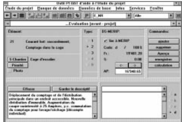
Figure 8.4: Disposition du masque d'écran pour le travail par élément en mode «avant-projet». Possibilité de supprimer ou de rajouter des éléments, de modifier le coût de l'élément, éventuellement à l'aide d'un tableau. Descriptif de l'intervention repris à partir du diagnostic sommaire ou modifié librement par l'utilisateur. Répartition du coût selon les genres de travaux (classification selon le CFC du CRB).
