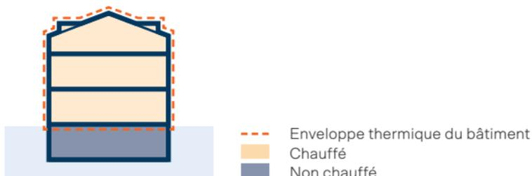
Pour transformer l'espace froid que constituent les combles en un espace habitable, il faut poser une isolation thermique au niveau de la charpente. L'isolation est placée sous, dans ou sur la structure porteuse. Il faut veiller scrupuleusement au respect des exigences en matière de physique du bâtiment (entre autres étanchéité à l'air et protection thermique estivale). L'épaisseur d'isolation recommandée est de 20–30 cm.
