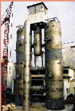
L'installation d'essai thermohydraulique PANDA au PSI sert à démontrer le fonctionnement de systèmes de sûreté passifs.
