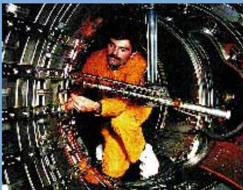
Collaboration internationale dans le domaine de la fusion nucléaire: développés en Suisse, des revêtements intérieurs du Tokamak à base de carbure de bore (ici le JET) maintiennent le plasma quasiment à l'abri des impuretés.
