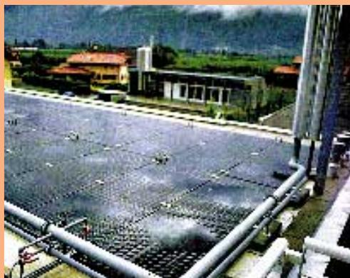
Depuis 1990, un banc d'essai et de recherche sur les capteurs solaires, pionnier en Europe, est en place au Technicum intercantonal de Rapperswil. Sur l'image, on voit le stand en plein air doté d'un système de mesure automatisé.
