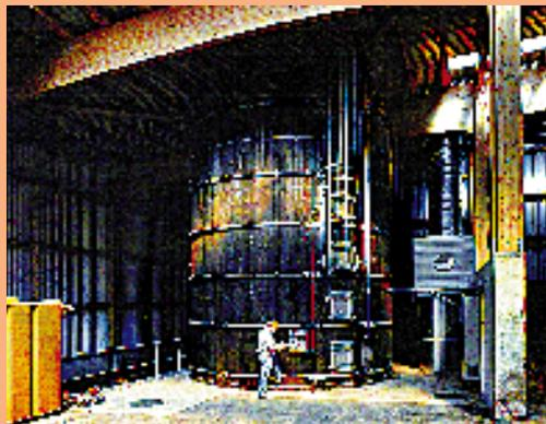
Ce composteur à Baar traite 18'000 t de déchets biologiques par année. Le nouveau procédé fournit même un excédent de courant et ne produit pas d'eaux usées grâce à un biofiltre (sur l'image) destiné à purifier l'air évacué.
