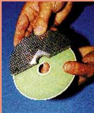
Pile HEXIS: anode (verte) et électrolyte (blanc), plaque cannelée pour l'aménage de combustible et l'évacuation des produits de combustion.
