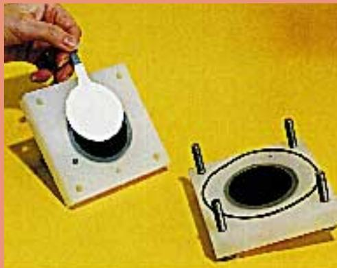
Composants de la pile zinc/air: la main tient l'électrode de zinc enveloppée dans un matériau de séparation poreux; la partie sombre dans le boîtier est l'électrode bifonctionnelle à air.
