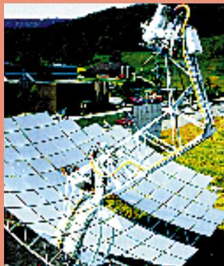
Au foyer du miroir parabolique de 90 m<sup>2</sup> du PSI est disposé un réacteur solaire à cyclone de 56 kW, chauffé par le rayonnement solaire concentré.
