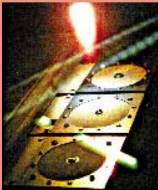
Fabrication simultanée de plusieurs éléments HEXIS de 12 cm de diamètre à l'aide de la projection sous vide au chalumeau à plasma.
