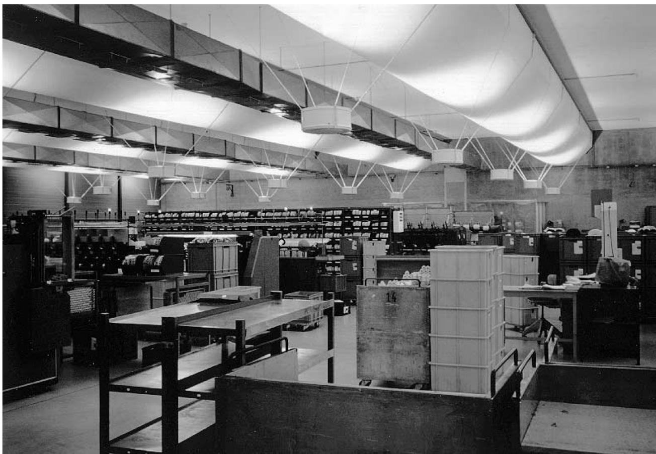
Fig. 1.7 : Illustration d'un atelier de production de fil après rénovation de l'installation d'éclairage (éclairage indirect).
