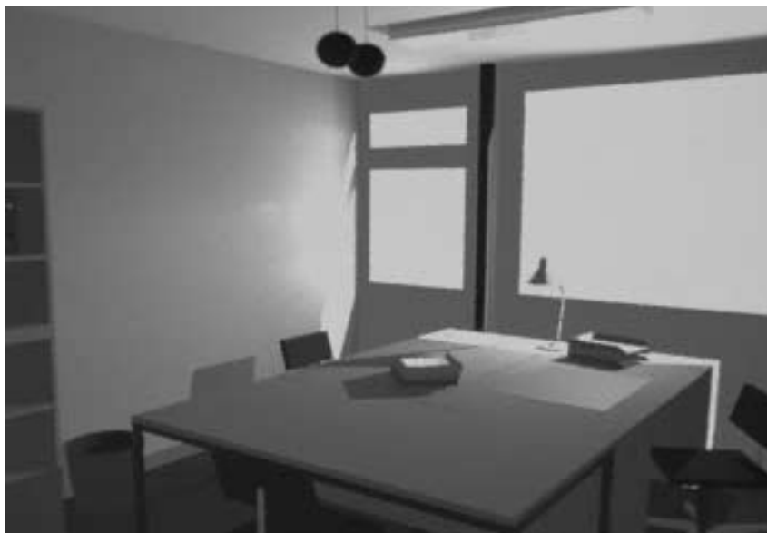
Figure 2.26: Visualisation infographique d'un local éclairé par la lumière naturelle (unité solaire du LESO-PB/EPFL, logiciel ADELIN / RADIANCE).
