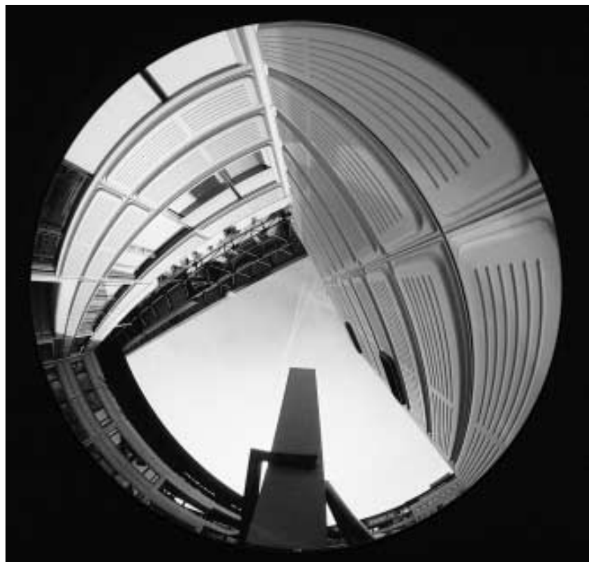
Figure 5.3: Masque produit par l'environnement (photo œil-de-poisson)
