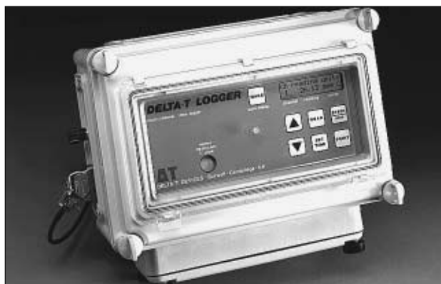
Figure 79: Datalogger (source: Flexum Messtechnik AG, 8636 Wald).
