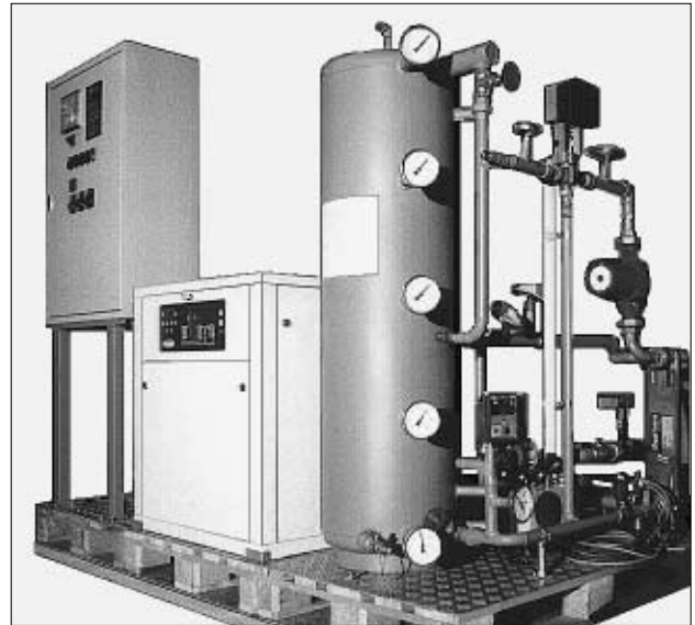
Figure 74 : Ce modèle de pompe à chaleur (schéma de principe cf. figure 75) sera présenté au cours de perfectionnement RAVEL. On peut ainsi démontrer pratiquement comment la pompe à chaleur est intégrée dans un système global. A gauche, l'armoire de distribution, au milieu la pompe à chaleur, à droite l'accumulateur et l'installation d'utilisation de chaleur avec échangeur à plaques.
