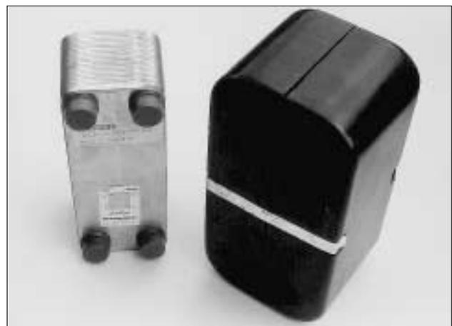
Figure c22 Echangeur à plaques
