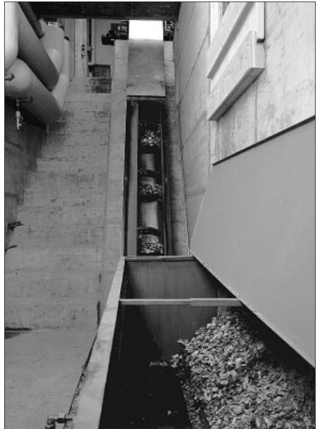
Systèmes de chargement et d'extraction à convoyeurs à chaîne et à racloirs, mobiles horizontalement et verticalement
