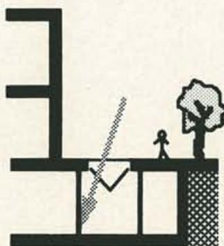
Ici, nous voyons un exemple non conventionnel d'éclairage d'un couloir en sous-sol. Le triangle à pointe en bas permet de libérer l'espace supérieur public pour la circulation piétonne. Aucun obstacle en surface; une simple grille protège les vitrages souterrains.
