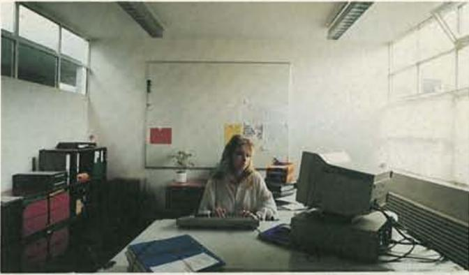
Des locaux éclairés de deux côtés gagnent en luminosité. Le couloir n'est plus l'endroit le plus sombre, mais devient lui-même source de lumière. Celle-ci pénètre dans les bureaux par des fentes lumineuses près des plafonds ou par des vitrages inclinés judicieusement placés.
