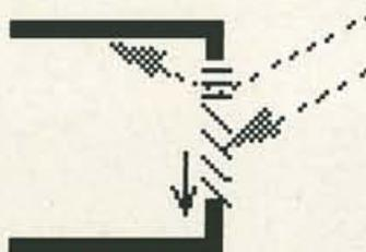
De telles lames, couvrant le tiers supérieur des fenêtres, protègent l'utilisateur d'un excès de soleil. Elles ont une double fonction d'ombrage, mais aussi de réflexion de lumière sur leur face supérieure. Dans la partie basse de la fenêtre, on prévoira un store à lamelles, à manipulation individuelle.
