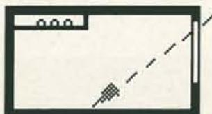
Plus la fenêtre est haute, plus profondément la lumière du jour pénètre dans les pièces. S'il est impossible de se passer d'un faux-plafond, du moins éviter de le prolonger jusqu'au droit de la façade.
