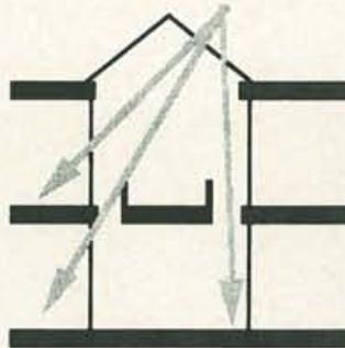
Les ruelles intérieures sont ici entièrement couvertes d'une verrière. Les passages supérieurs sont en forme de passerelles, dissociées de la façade, de manière à ne pas entraver la pénétration de lumière dans les étages inférieurs.
