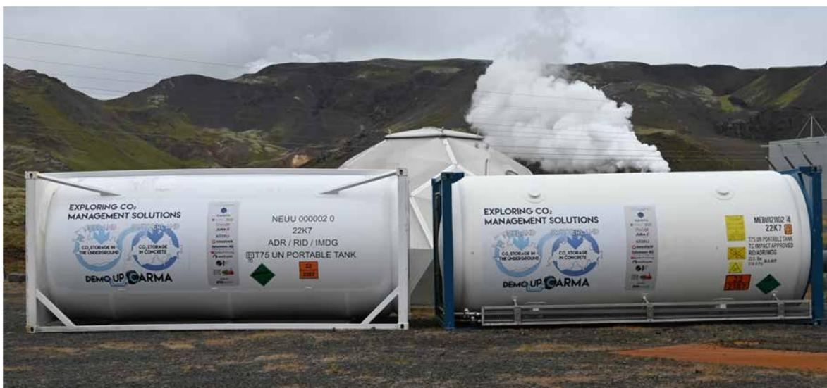
Le CO<sub>2</sub> liquéfié est transporté de la Suisse vers l'Islande dans des conteneurs spéciaux par camion, train et bateau (source: DemoUpCARMA/EPF Zurich).
