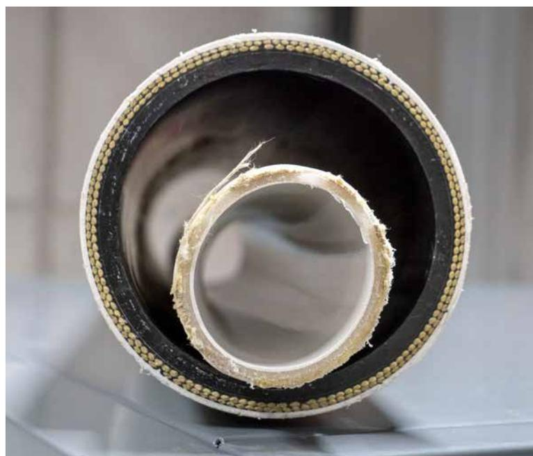
Pour des raisons de sécurité, la conduite interne transportant le CO<sub>2</sub> est entourée d'un autre tuyau. Les deux tuyaux supportent une pression de 90 bars (source: HES-SO Valais-Wallis).
