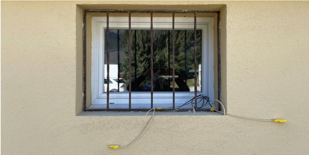
Des capteurs ont permis de mesurer pendant un an la température et l'humidité de l'enduit isolant à base d'aérogel appliqué sur le bâtiment de Lenzerheide. Photo: Daniel Sanz Pont
