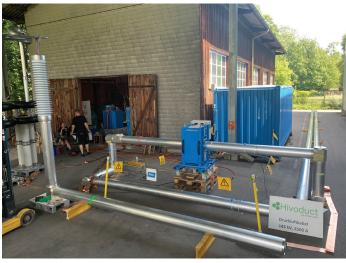
Avant la construction de l'installation de démonstration à Zurich-Seebach, les câbles à air comprimé avaient été testés dans le cadre d'un projet Innosuisse et en collaboration avec la Haute école spécialisée de Suisse orientale sur un banc d'essai de la Commission spécialisée pour les questions de haute tension (Versuchsanstalt Dänikon). Photo : Hivoduct
