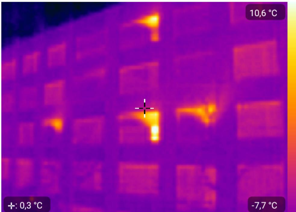
Examen de la façade à l'aide d'une caméra thermique: Les surfaces claires montrent des fenêtres ouvertes. La fuite d'air chaud lorsque les fenêtres sont ouvertes (basculantes) a un impact relativement important sur les bâtiments bien isolés. Photo : VenTSol
