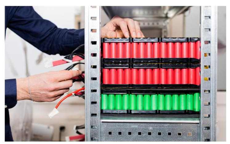
L'intérieur d'une batterie de seconde vie vendue par l'entreprise zurichoise Libattion sous le nom de «e-Brick»: les 196 cellules de la batterie proviennent de vélos électriques et permettent une capacité de stockage d'environ 2,5 kWh. Pour la comparaison: La batterie d'un vélo électrique se compose typiquement de 50 cellules avec une capacité de stockage d'environ 0,5 kWh. Photo: Libattion
