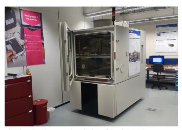
Chambre climatique pour l'étude des cellules de batteries au CSEM à Neuchâtel. La température peut être réglée entre -45°C et +180°C. La chambre climatique aide à tester les cellules de la batterie dans des conditions environnementales contrôlées. Tous les tests réalisés dans le cadre du projet BAT4SEL ont été effectués à 20°C. Les résultats sont présentés dans le tableau ci-dessous. Photo: CSEM
