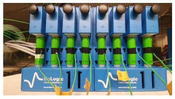
Un banc d'essai qui permet de tester les performances des batteries de vélos électriques d'occasion. Photo: CSEM
