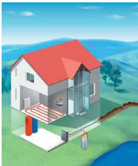
Figure 2.27: PAC eau-eau; source de chaleur: captage de l'eau souterraine. (Source: BKW)
