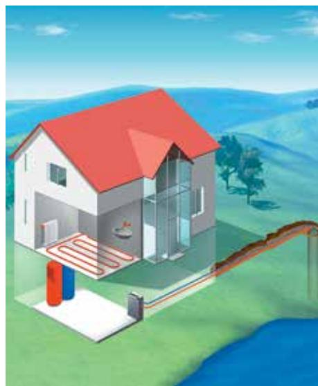
Figure 2.28: PAC saumure-eau; source de chaleur: sondes géothermiques. (Source: BKW)
