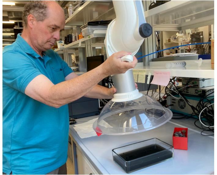
Le professeur Fabian Fischer recouvre un échantillon de boues d'épuration de la STEP de Châteauneuf avec une hotte aspirante afin de réduire les nuisances olfactives. Les boues d'épuration, dont la teneur en matières solides est d'environ 3%, sont transformées en méthane dans la cellule d'électrolyse microbienne avec un rendement élevé. Photo: B. Vogel
