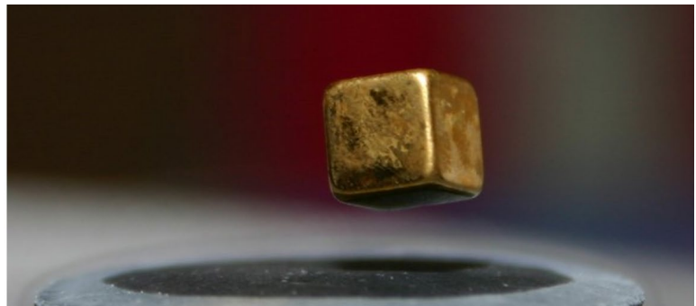
Figure 12: (À gauche) Au-dessous d'une certaine température (température de transition), les supraconducteurs ne présentent aucune résistance électrique. Il est possible de construire des accumulateurs électriques à l'aide de bobines supraconductrices en stockant l'énergie dans le champ magnétique des bobines. (À droite) Découverts dans les années 80 (prix Nobel de physique en 1987 pour les chercheurs Müller et Bednorz du centre de recherche d'IBM, https://link.springer.com/content/pdf/10.1007/BF01303701.pdf ), les supraconducteurs à haute température affichent des températures critiques de l'ordre de 90 K et plus. Photo: un aimant volant au-dessus d'un supraconducteur à haute température pour illustrer l'état supraconducteur (effet Meissner-Ochsenfeld).
