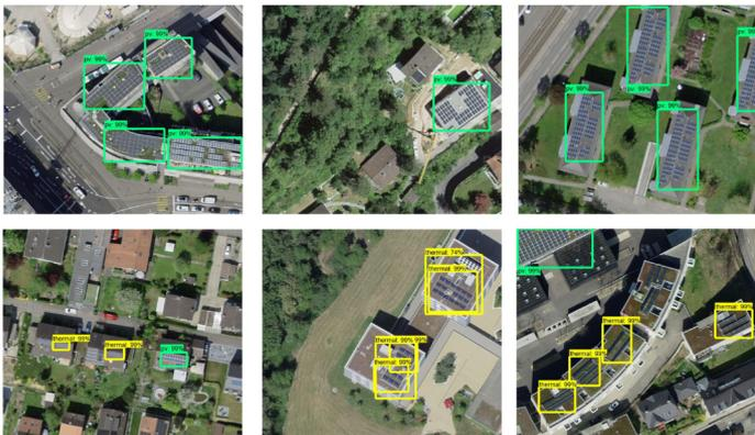
Une première étape préparatoire vers l'apprentissage automatique: une personne encadre manuellement toutes les installations solaires sur des images aériennes: les installations PV en vert, les installations solaires thermiques en jaune. Avec ces photos, l'algorithme a été formé pour reconnaître les installations solaires en tant que telles sur les images aériennes. Photos: FHNW
