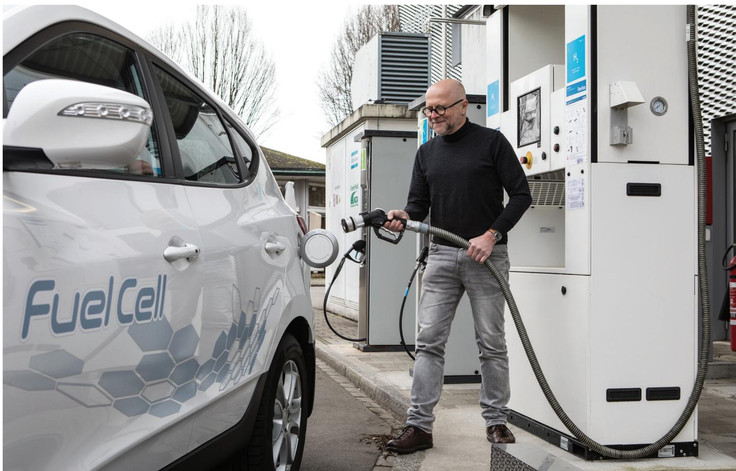
Un des cinq types de véhicules dont l'équipe de chercheurs de l'ETH Zurich et de l'Empa a examiné la consommation réelle: le Hyundai ix35 Fuel Cell est équipé d'une pile à combustible qui convertit l'hydrogène en électricité sans combustion pour alimenter le moteur électrique. Photo: Empa
