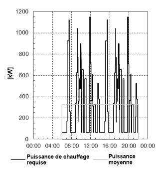
Profil de charge d'un processus discontinu de l'industrie textile. Dans la mesure où les besoins en chaleur varient fortement, l'installation d'un accumulateur de chaleur est primordiale. Graphique: Rapport intermédiaire BillySolar
