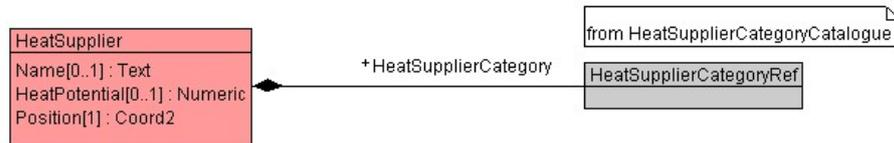
Abbildung 2: UML Diagramm Thema «HeatSupplier»
