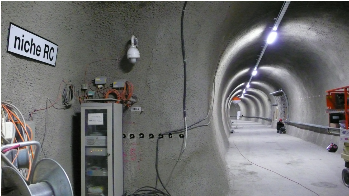
Figur 3: Nische des RC-Experiments mit den Beobachtungsbohrungen parallel zur Galerie-2008 (Quelle: ENSI)
