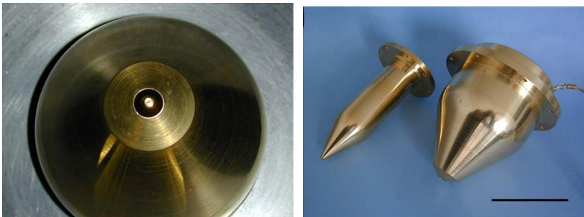
Fig. 2: Ringdüse zusammengebaut von vorne (links). Der schwarze Punkt im Zentrum entspricht der Düse, durch welche Zinkdampf austritt. Der Ringspalt für den Sauerstoff ist als dunkler Ring sichtbar. Im Bild rechts ist die Düse demontiert gezeigt. Die Zinkdüse (Bauteil links) wird in das Bauteil rechts eingeschoben und bildet so den Ringspalt für den Sauerstoff. Der Balken im Bild entspricht 10 cm.
