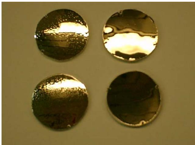
Fig. 3a: Al-beschichtete MDPE-Proben: links unbeflammte Seite, rechts beflammte Seite.
