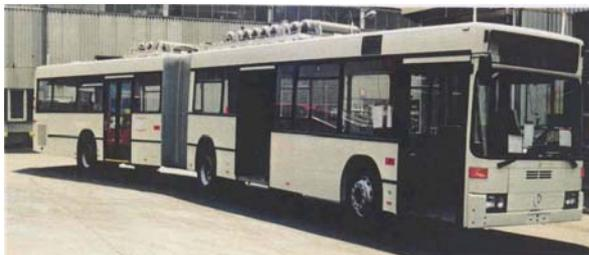
Fig. 1a: Bus mit 12 Behältern à  $126 \text{ l CH}_4/200 \text{ bar}$ .
