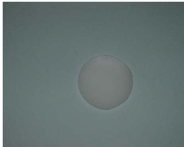
Fig. 3b: MDPE-Probe: MDPE-Probe mit einer 150 nm dicken Al<sub>2</sub>O<sub>3</sub>-Schicht.
