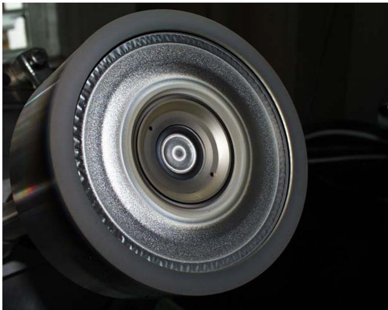
Fig. 7: Ringmagnetron (Aussendurchmesser 108 mm) im frisch konditionierten Zustand.
