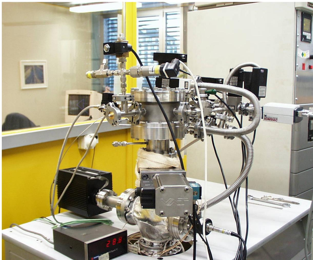
Fig. 2: VPP-Messapparatur an der EIG
