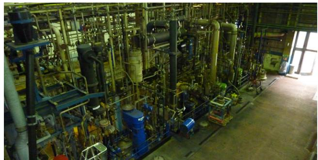
Figur 3: Reaktorenreihe einer realen, verfahrenstechnischen Batch-Produktionsanlage.
