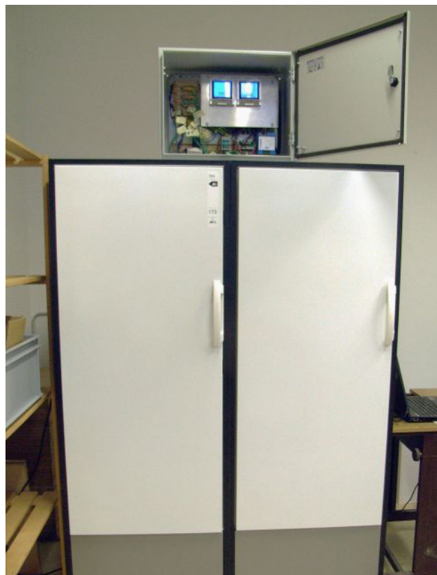
Figur 5: Referenzkühlschrank (links) und modifizierter Kühlschrank (rechts), eingebaut in das gleiche Möbel, um identische äussere Bedingungen zu ermöglichen. Im Gehäuse oben befindet sich die Messelektronik (Quelle: awtec AG für Technologie und Innovation).
