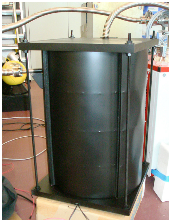
Figur 4: Funktionsmuster eines mit Vakuum-Spalt isolierten zylindrischen Kühlschranks (Quelle: Helbling Technik AG).
