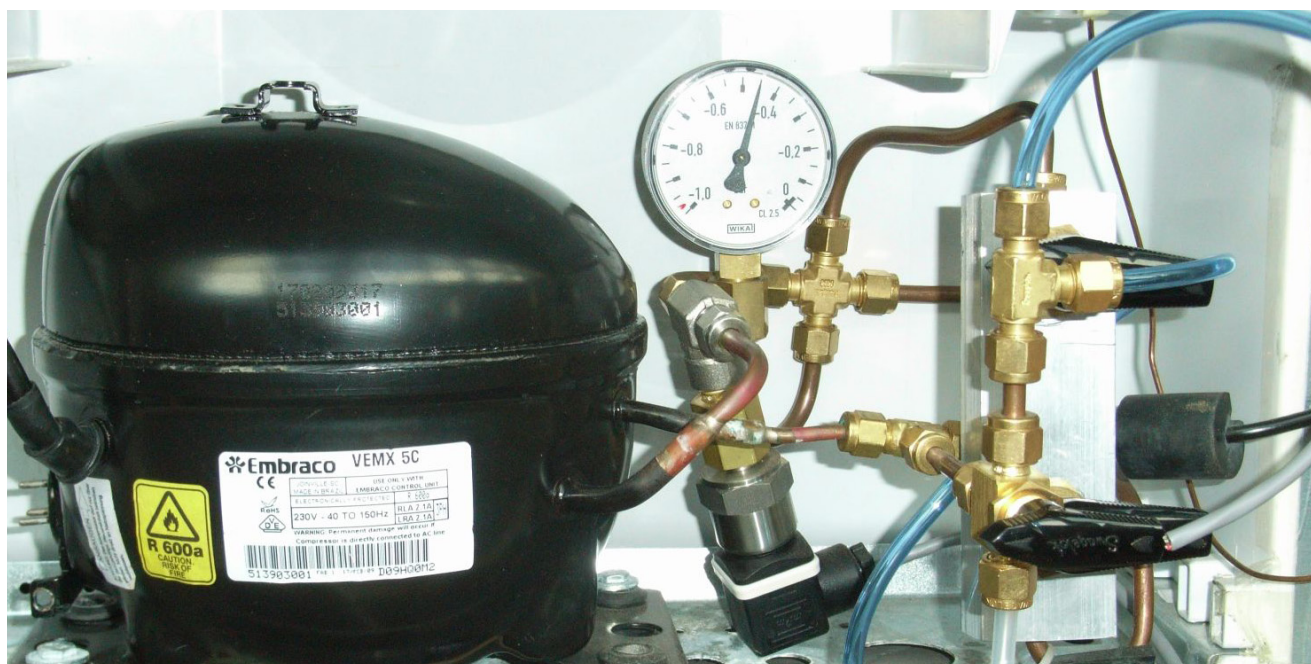
Figur 6: Drehzahl geregelter Kompressor Embraco VCC3 VEM X5C mit Befüllsystem, eingebaut in einem modifizierten Kühlschrank (Quelle: awtec AG für Technologie und Innovation).
