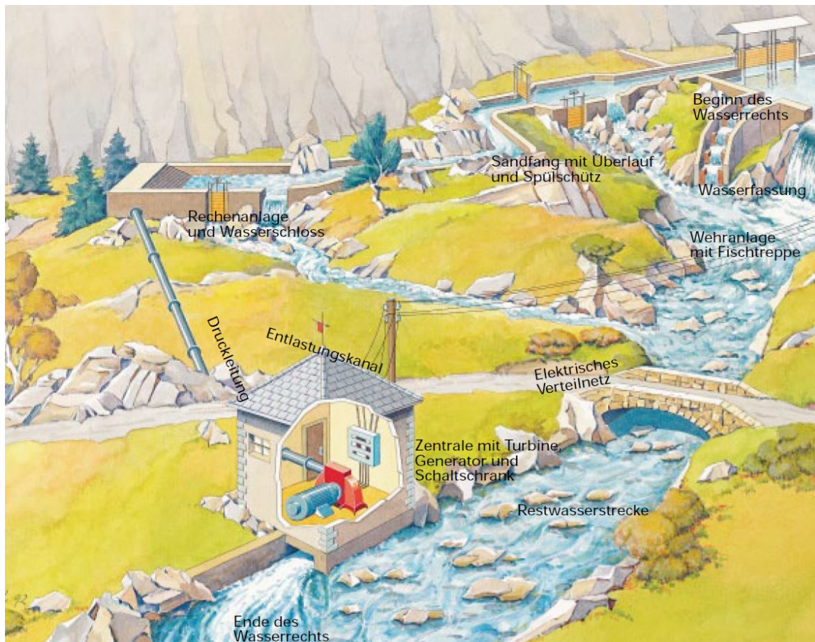
Abbildung 2-1 Allgemeine Anordnung eines Kleinwasserkraftwerkes, [3]
