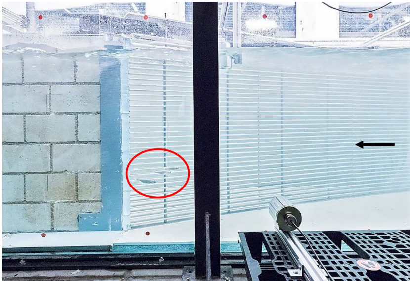
Abbildung 6-3 Untersuchung des Fischverhaltens vor einem horizontalen Stabgitter [66]
