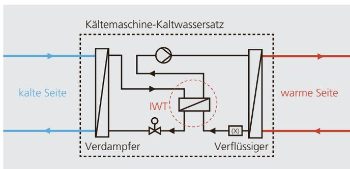
Anhand des Isentropen-Exponenten erkennt man, wie gut sich ein Kältemittel für eine Unterkühlung mittels IWT eignet. Je höher der isentrope Exponent ist, desto höher wird die Endverdichtungstemperatur und desto weniger eignet sich ein Kältemittel dafür. Eine Faustregel besagt, dass sich Kältemittel mit einem isentropen Exponenten nahe gegen 1,0 für eine Unterkühlung besonders eignen.
