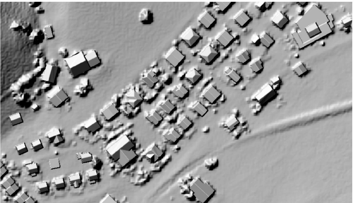
**Abbildung 2:** Hillshade des kombinierten digitalen Oberflächenmodells (kDOM) mit der Hierarchie: swissBUILDINGS<sup>3D</sup> 2.0 → DOM → swissALTI<sup>3D</sup> → SRTM. Im Vergleich zu **Abbildung 1** fallen die scharfen Dachformen und die neuen Gebäude im linken Bildbereich auf.
