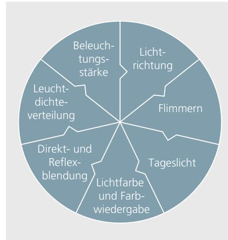
Abbildung 4.24: Gütemerkmale der Beleuchtung nach SN EN 12464-1: 2011. (Quelle: Trilux)
