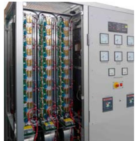
Computergesteuerte Solargenerator-Simulatoren dienen der Untersuchung von Wechselrichtern unterschiedlicher Leistungsklassen.
