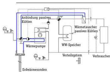
Im Schweizer Beitrag wurde die hydraulische Integration einer Kühlfunktion mit Sole-Wasser-Wärmepumpen ohne simultane Kühloption untersucht.
