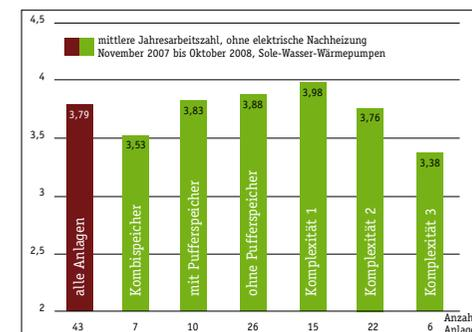
Feldtest-Resultate: Abhängigkeit des Nutzungsgrads von der Systemkonfiguration der Sole-Wasser-Wärmepumpen. Grafik Fhg-ISE
