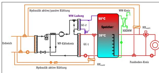
Systemkonfiguration des österreichischen Prototyps einer Sole-Wasser-Wärmepumpe mit 5 Kilowatt Leistung und dem Kältemittel CO<sub>2</sub>.
