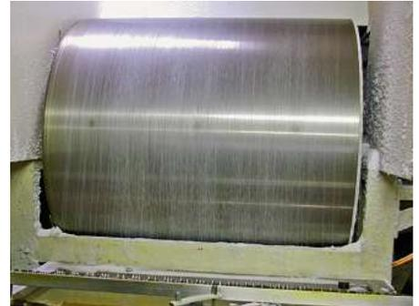
Versprühtes Paraffin wird auf der gekühlten, rotierenden Trommel zu Granulat, das anschliessend zu kalt gepressten Kerzen verarbeitet wird
