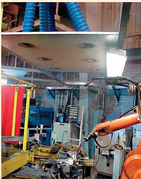
*Absaugung bei Schweißrobotern in der Automobilindustrie*
