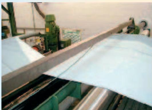
Vakuumsaugbalken zur Vortrocknung von Stoffbahnen in der Textilindustrie
