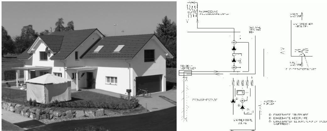
**Abbildung 8:** Ansicht des Gebäudes Feldmessung Muolen (links) und Hydraulikschema (rechts)
