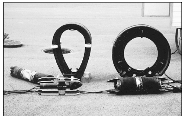
Abb. 4.6 Injektions-Packer für unterschiedliche Leitungsdurchmesser und -formen.
