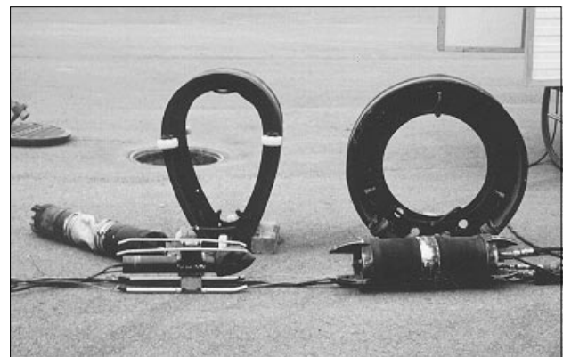
Abb. 4.6 Injektions-Packer für unterschiedliche Leitungsdurchmesser und -formen.
