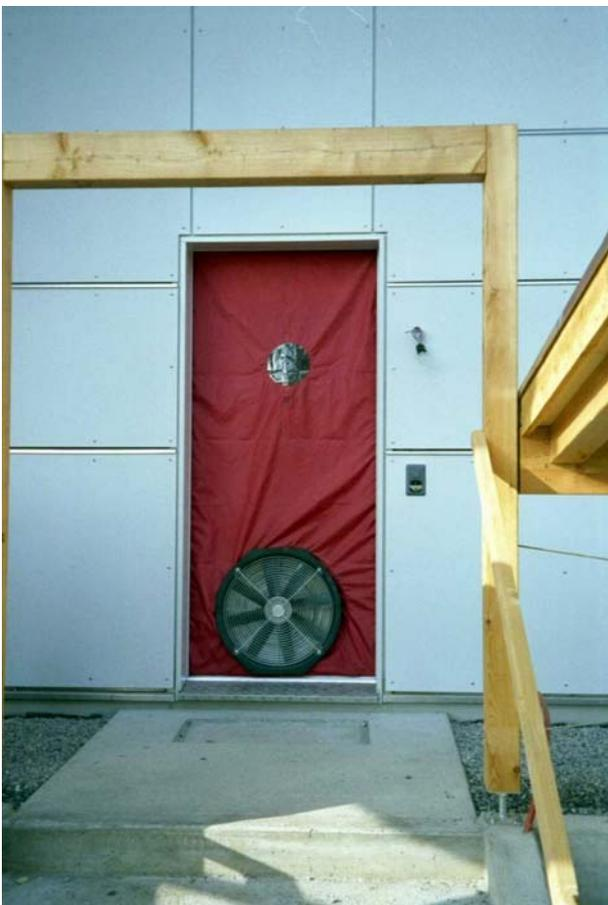
Blower-Door Luftdichtkeitsmessung Aug. 01
